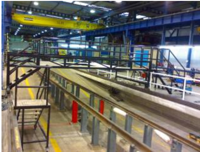
← Nueva situación de vía 14 con plataforma de acceso a bogies
